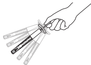
Slika 2: Ponovno postavljanje vrijednosti temperature toplomjera
