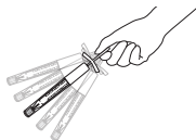
2. kép: A hőmérő hőmérsékleti értékének visszaállítása
