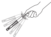
Zdjęcie 2: Resetowanie wartości temperatury termometru
